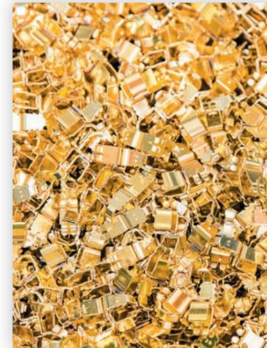
Die galvanische Trommelveredelung in rotierenden oder schwenkbaren Trommeln ist ein kostengünstiges Verfahren, das es ermöglicht große Bauteilmengen in kurzer Zeit zu fertigen.
