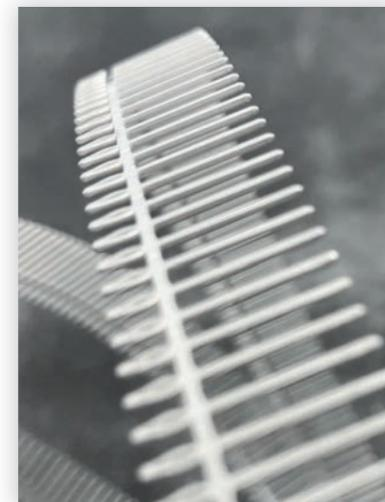
Die Bandbeschichtung ist ein Verfahren zur kontinuierlichen galvanischen Veredelung von Stanz- oder Vollbändern. Es werden zumeist Steckverbinder, elektrische Kontakte oder andere Komponenten für die Automobilindustrie in hohen Stückzahlen gefertigt.
